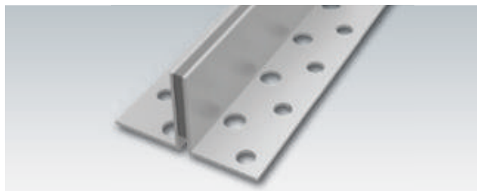
Schwundfugenprofile aus Aluminium , Materialstärke: 2 mm , Breite der Zellkautschukeinlage: 5 mm
