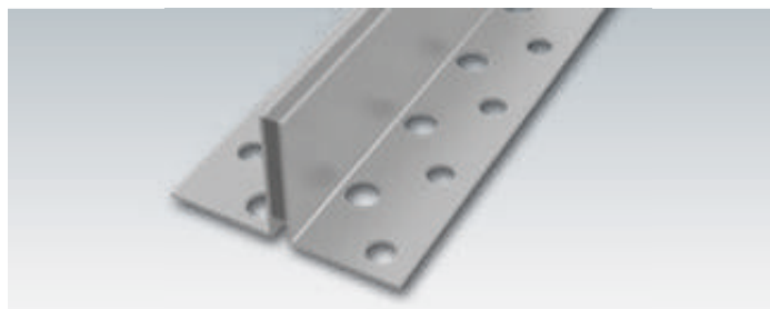
Schwundfugenprofile aus Edelstahl , Materialstärke: 1,5 mm , Breite der Zellkautschukeinlage: 5 mm
